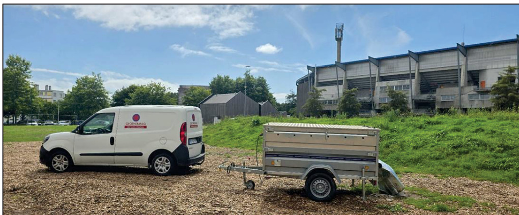
Figure 2 : Banc de test de réponse thermique en fonctionnement
