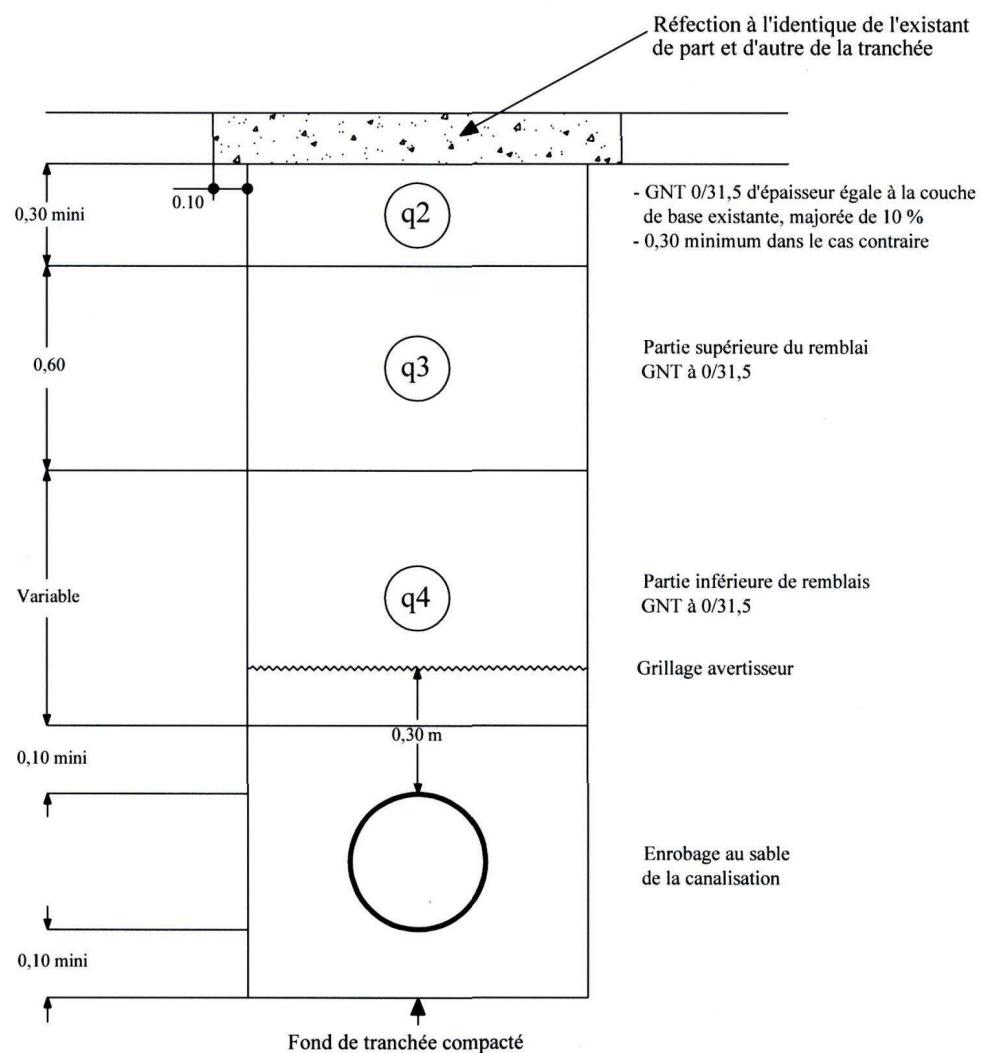
q2,q3,q4 : qualité de compactage (conformément aux objectifs de densification définis dans la norme " Tranchées " NF P 98-331 )
