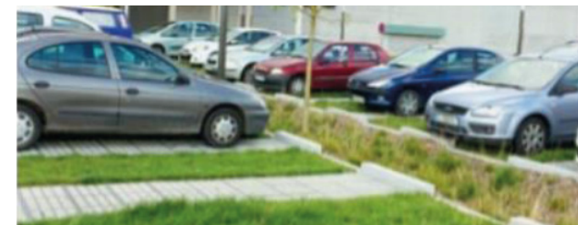
Noue végétalisée avec infiltration gravitaire du ruissellement
