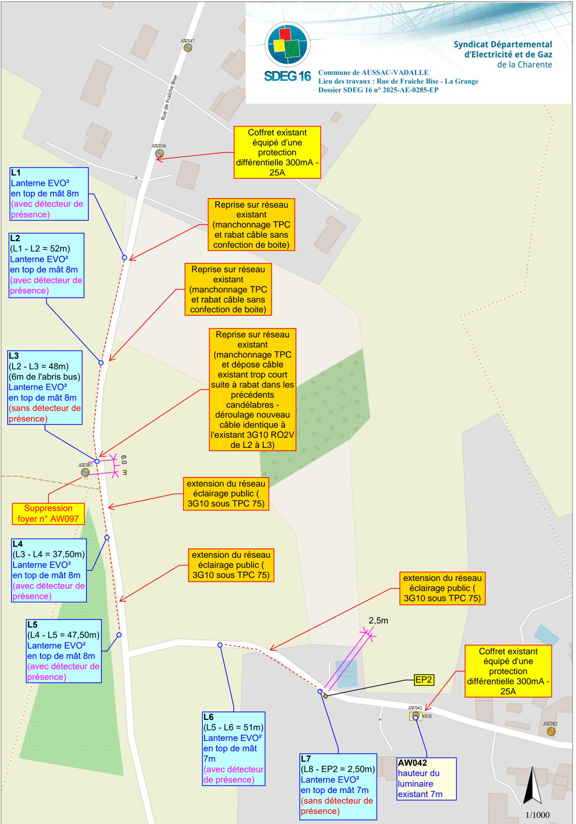
Coffret existant équipé d'une protection différentielle 300mA - 25A
