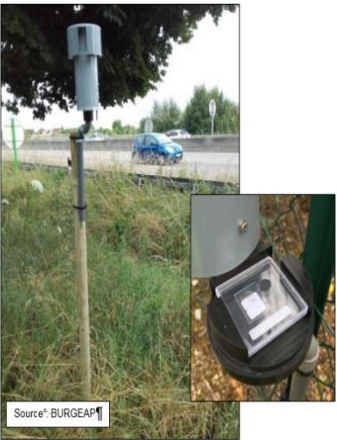
Figure 169 : Photographie du dispositif de prélèvement des poussières PM10 - Source : BURGEAP
