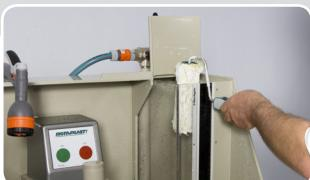
Placer le rouleau dans le «nettoyeur de rouleaux» derrière la protection anti-éclaboussures, tenir la poignée du rouleau et déclencher l'alimentation d'eau.
