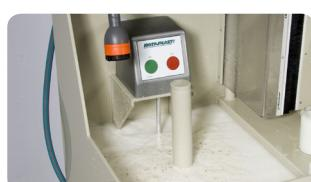
Tirer l'obturateur afin de faire écouler l'eau progressivement à travers les filtres.
