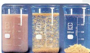
A l'arrêt automatique du mélangeur, l'eau est décanlée.
