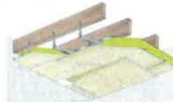
Les plafonds Placostil® sur fourrures sont constitués de plaques de plâtre Placo® vissées sur une ossature métallique Placostil®. Quel que soit le type de support (bois, métal, béton, hourdis) les plafonds Placostil® permettent de répondre à toutes les contraintes :
