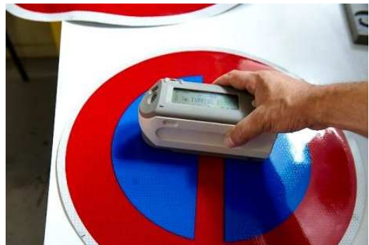
Contrôle de colorimétrie à l'aide d'un spectrocolorimètre Konica Minolta
