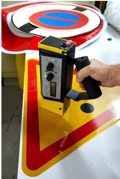
Contrôle de rétro réflexion à l'aide d'un rétro réflectomètre Méchatronic
