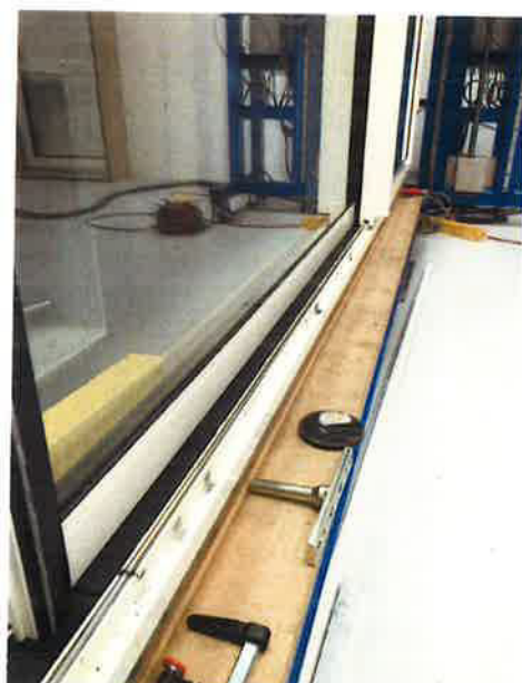
Traces sur le chemin de roulement
