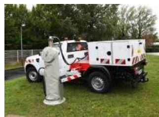
Mesure de la portance à la plaque & Module de Westergaard et à la Dynaplaque
