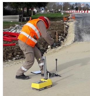
Mesure de la masse volumique moyenne apparente sur les matériaux routiers au gammadensimètre ou électrodensimètre.
