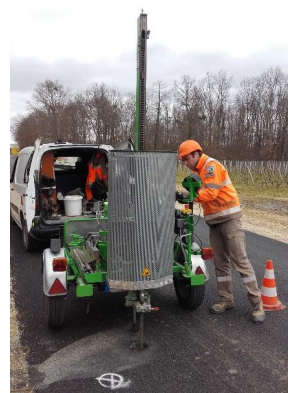
Détermination de la résistance dynamique du sol au pénétromètre
