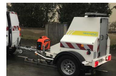
Mesure de la déflexion sous chargement dynamique
