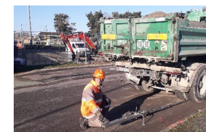
Mesure de la déflexion engendrée par une charge roulante
