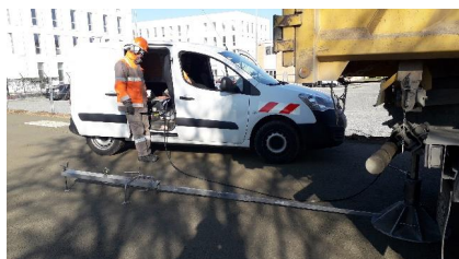
Mesure de la portance à la plaque & Module de Westergaard et à la Dynaplaque
