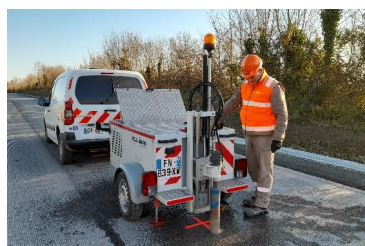
Détermination des épaisseurs de couches bitumineuses par carottage
