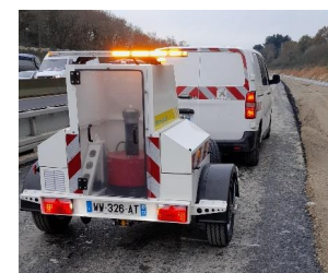
Détermination de la résistance dynamique du sol au pénétromètre
