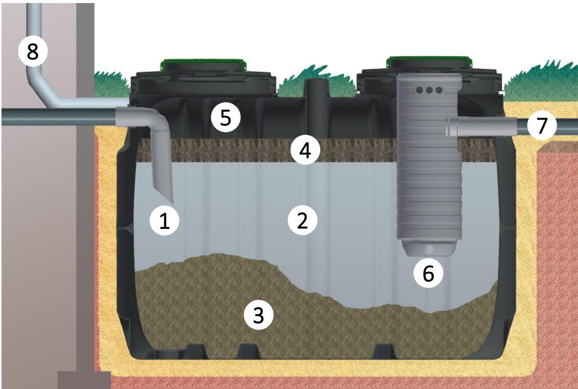
1 Arrivée des eaux usées domestiques brutes par un dispositif d'entrée permettant un accès pour le décolmatage et la décompression
