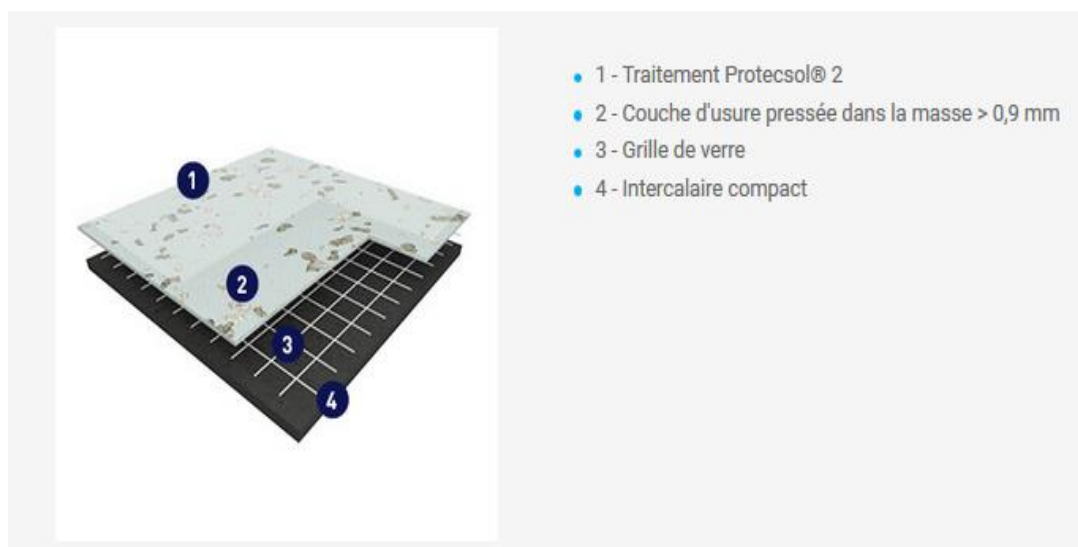
Figure 1 : illustration du principe de fabrication du produit Taralay Premium Compact
