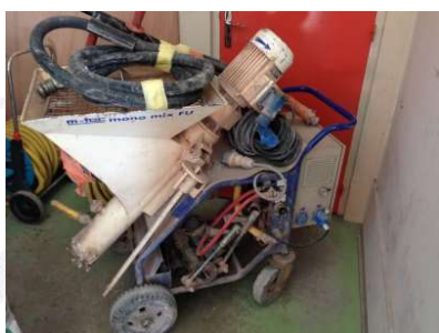
Machine utilisée pour l'application mécanique du ragréage.
