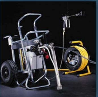
*Cette machine Airless à membrane est équipée d'une double buse et d'un tuyau chauffé A + 40°C, garantissant une fluidité constante de la peinture. Elle permet donc une application par projection avec un brouillard inférieur à 1cm de rayon.*
